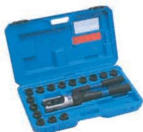
Herramienta hidráulica compacta, robusta y manejable que ofrece dos velocidades, una rápida para realizar un ajuste de la matriz sobre el conector y otra lenta y precisa para realizar el crimpado. Cabezal giratorio hasta 180°. Esta sofisticada herramienta incorpora una válvula de seguridad que suministra aceite cuando se alcanza la presión máxima y un sistema de descompresión, fácil de accionar, en todo el proceso de crimpado.
