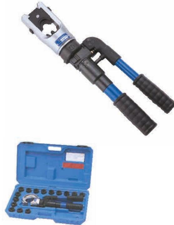
Herramienta hidráulica robusta, compacta y muy manejable. Las matrices pueden ser ajustadas con una sola mano, dejando la otra libre para sujetar el conector. Admite matrices con un crimpado profundo sobre cables de aluminio. Esta sofisticada herramienta incorpora una válvula de seguridad que suministra aceite cuando se alcanza la presión máxima y un sistema de descompresión, fácil de accionar, en todo el proceso de crimpado.
